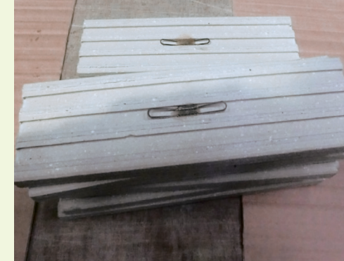
写真・2 脱落防止金物の取付1
