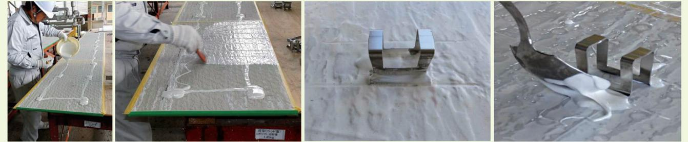
写真・1 裏面処理材の流し込み 写真・2 へら押し 写真・3 AMクランプ周り 写真・4 クランプ周りの充填
