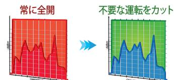
デマンドコントロールシステムによる換気風量削減
