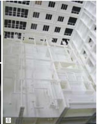
①大手製造メーカー新社屋基本設計承認用 地形データも取り込み表現 ② ArchiFuture2008出展の「開花亭 sou-an」模型 微細な外壁ルーバーは三重構造 ③④プレキャスト工法説明用模型 中国現地で技術者の理解をサポート ⑤⑥意匠・構造・設備統合模型 ダクトや設備の配管までを再現
