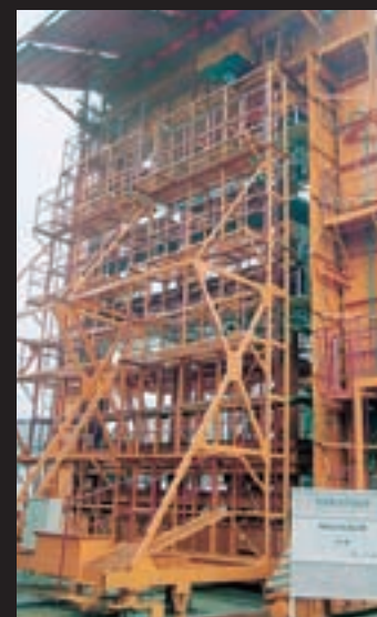
第2回層間変位追従性能試験 観察状況(その1) 〔層間変位量1/60,+63.3mm〕
