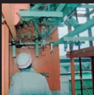
第2回層間変位追従性能試験 観察状況(その5) 〔層間変位量1/60,+63.3mm〕
