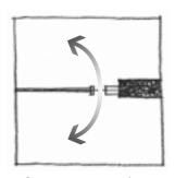
Cavcon●キャブコン 内蔵の調節弁により、強風時でも 一定の風量で換気ができ、無風時 でも内外の温度差による重力換気
