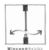
内蔵の調節弁により、風の強弱に 影響を受けにくく、定風量で換気が 行えるヨコ型定風量換気スリット。
